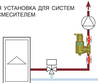
В нижней части корпуса деаэратора предусмотрено резьбовое соединение 1/2". При необходимости, может быть установлен дренажный кран арт. 3447
